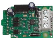
**REKAS 1** (42188) - Интерфейс для каскадного подключения до 32 электродкотлов. В каждом котле используется один интерфейс, отдельные интерфейсы подключаются параллельно, 3-жильным проводом. Все параметры и данные устанавливаются только на одном, ведущем котле, а остальные, ведомые котлы каскада работают по информации, выдаваемой ведущим котлом.
